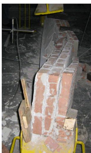
Entrambi gli elementi sono stati caratterizzati da una rottura di tipo pseudo-duttile legata al raggiungimento delle tensioni massime a compressione del laterizio, con il tessuto perfettamente ancorato tra i giunti di malta. Ciò testimonia un sovradimensionamento del materiale di rinforzo che andrà ottimizzato in successive fasi.
